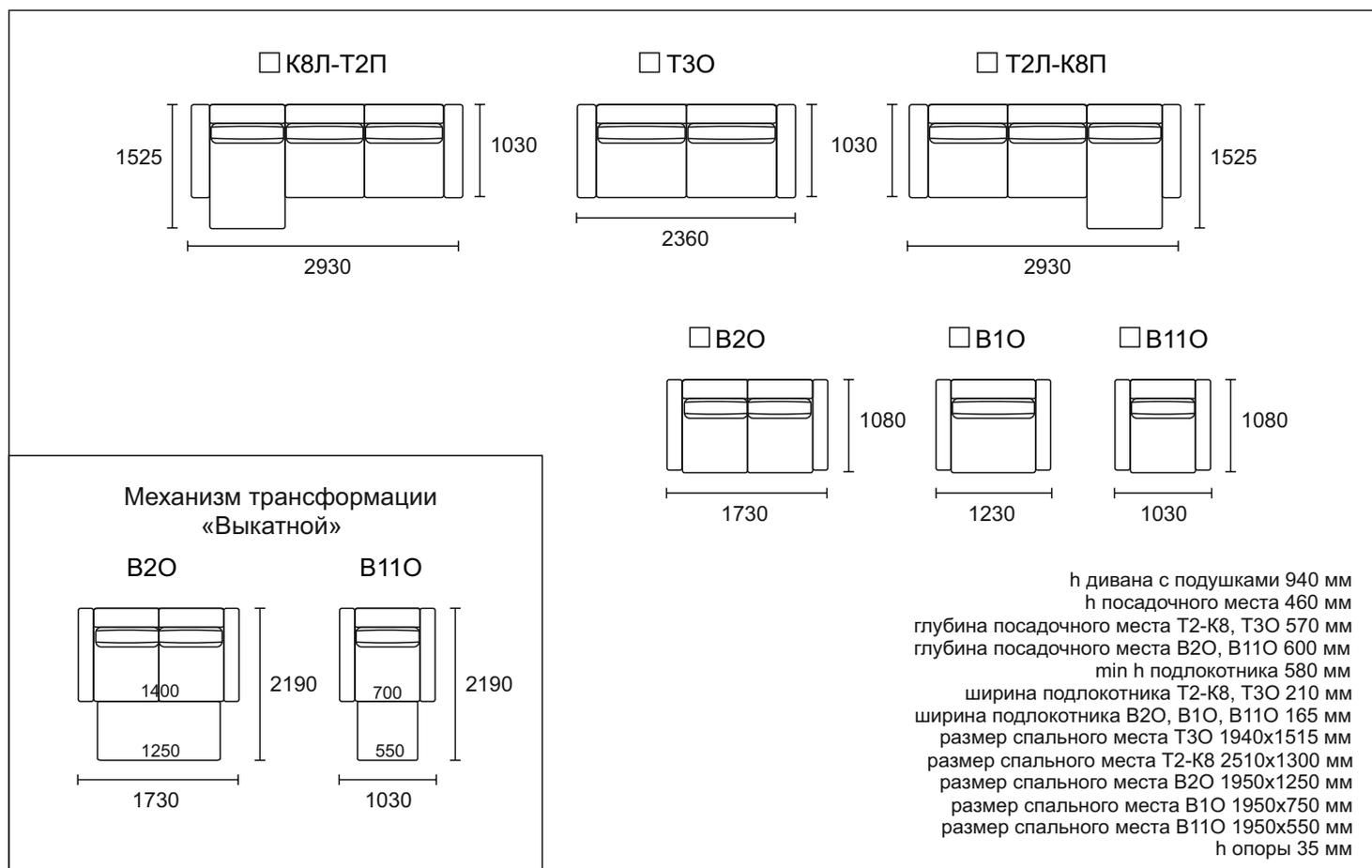
Согласно ГОСТ 19917-2014: для мебели, габаритные размеры которой определяются размерами мягкого элемента, предельные отклонения от габаритных размеров не должны превышать +/- 20мм.
